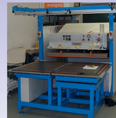
Thermodruckpresse mit feststehendem Presstisch und fahrbarer Heizplatte
