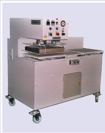
Thermodruckpresse mit fahrbarem Heiz- und Drucksystem
