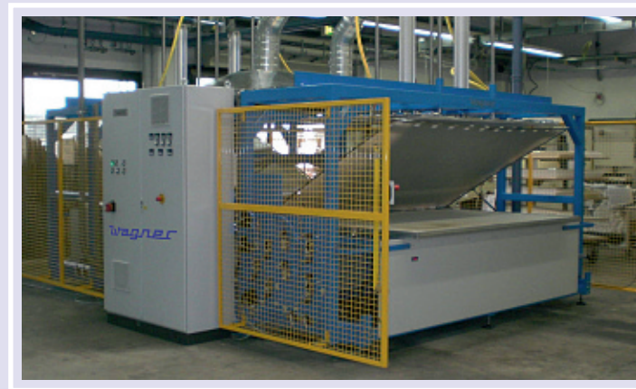
Vakuum-Infrarot-Maschine zum Sublimieren von Ski, Snow-, Kite- und Skateboards
